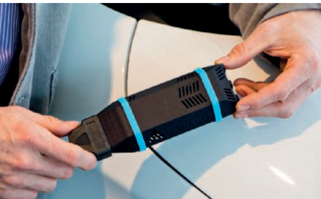
Aviloo hat das gesamte technische Know-how in einer kompakten Box verpackt; die lässt sich mit wenigen Handgriffen an die OBD-Schnittstelle anschließen und übermittelt mittels integrierter SIM-Karte die batterierelevanten Daten zur Auswertung
